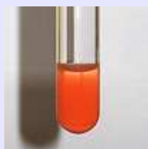
Oranžový oxid měďný vzniklý redukcí Fehlingova činidla.
